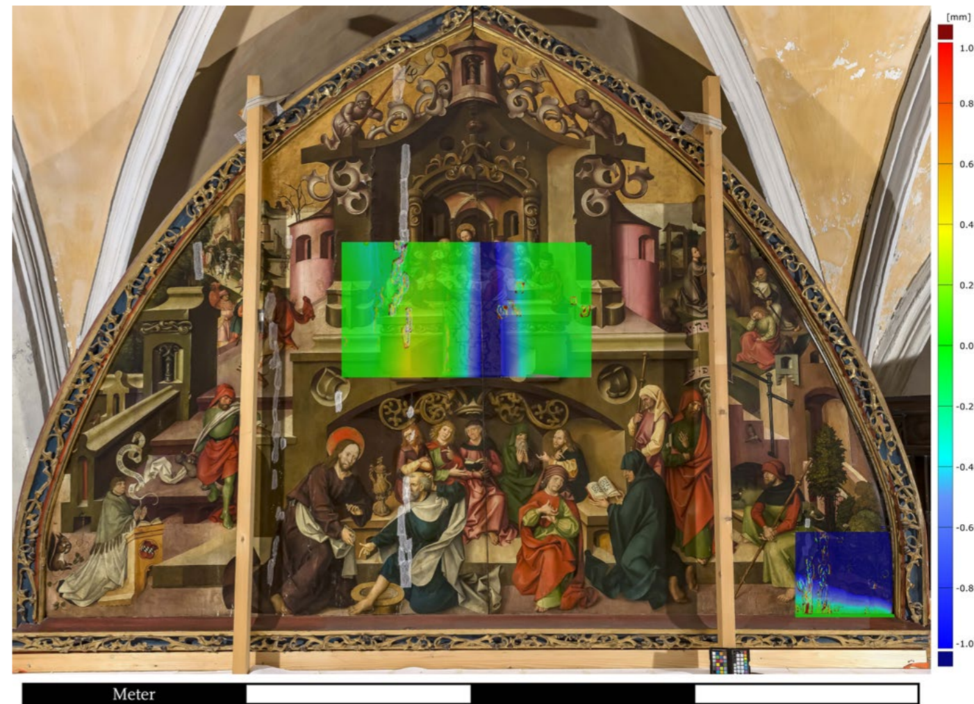
Darstellung der mittels Streifenlicht-Scanner erfassten Oberflächenveränderung zwischen 16. Februar und 24. März 2022 (Foto: Diözesanmuseum Freising, Walter Bayer, Bearbeitung: KDWT, Leander Pallas)
