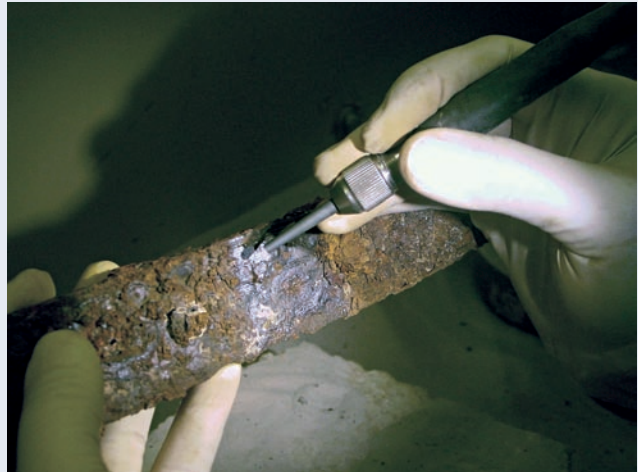
1. Fensterfreilegung an einer frühmittelalterlichen Spatha mittels Mikrofeinstrahltechnik (Foto: BLfD, Restaurierung)
