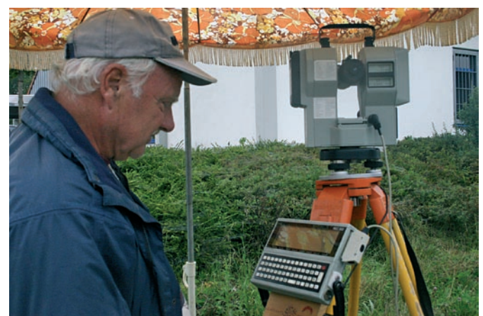
2. Eine Brandgrabgrube zeichnet sich als dunkle Verfärbung im Boden ab 3. Die Befunde werden nach dem Oberbodenabtrag tachymetrisch eingemessen (Alle Fotos: PLANAteam, München)
