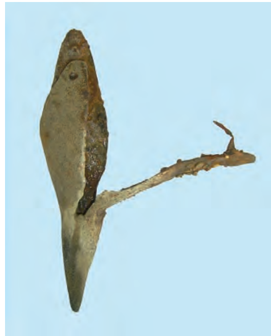
Deformierter dreilappiger Pfahlschuh von Pfeiler 3, Länge 41 cm (Foto: BGfU)
