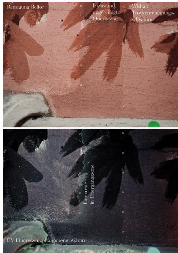
13. Malerei von 1934/35; Prüfung der UV-Fluoreszenzphänomene, 365 nm mit Vor- und Endzustand. Vorzustand: keine UV-Anregung, Endzustand SRF 2 NA: UV-Anregung in der weißen Grundierung, Endzustand Akapad, keine UV-Anregung, 2012
