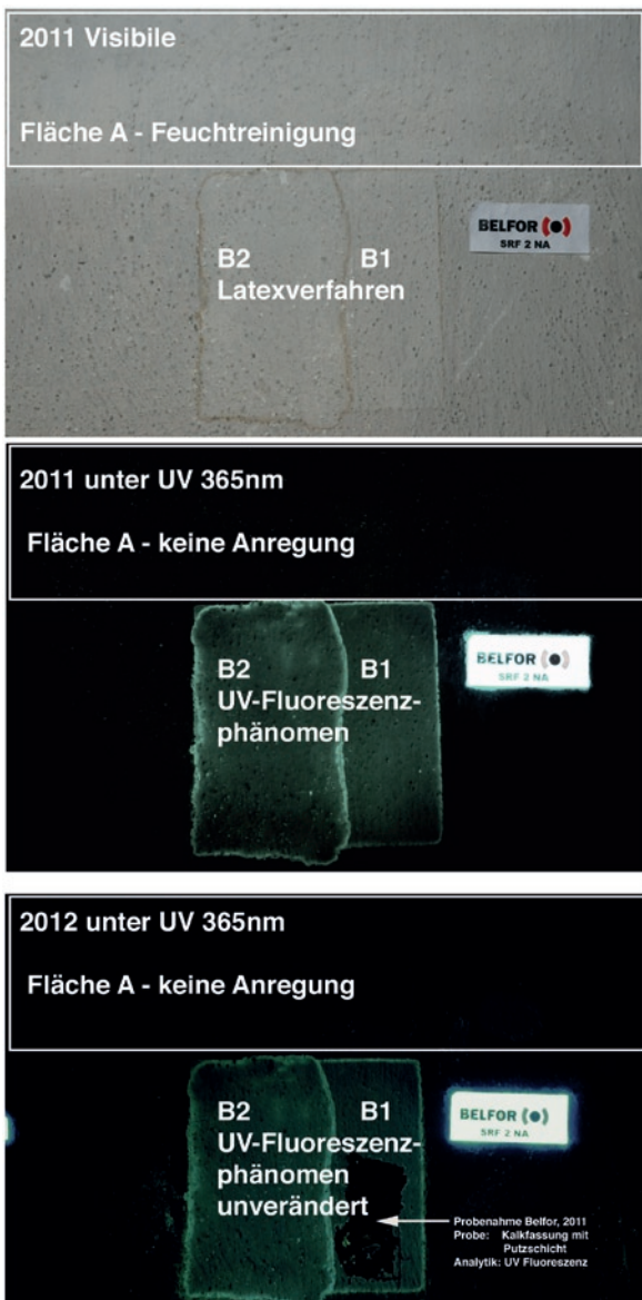
4. Architekturfassung von 1975, Musterfläche, Monitoring 2011/12 mit Gegenüberstellung Feuchtreinigung vs. SRF 2 NA (Foto/Montage: Peter Turek)
