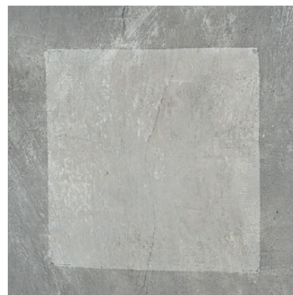
5. Probefläche nach 15 Minuten, der Latexfilm wurde abgezogen; die Fragmente der warmtonig grauen Lasur sind vollständig erhalten, Schmutzauflagen (Staub und Kerzenruß) optimal abgenommen
