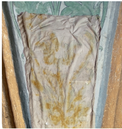
12. In der Fotomontage mit dem abgezogenen Latexfilm wird deutlich, dass Gelbfärbungen des Films mit Fragmenten der barocken Malschicht, genauer wohl mit dem Auftreten kupferhaltiger Grünpigmente korrelieren (Kompressenwirkung unter Einfluss des basischen pH-Werts des Latex, s. auch Abb. 15)
