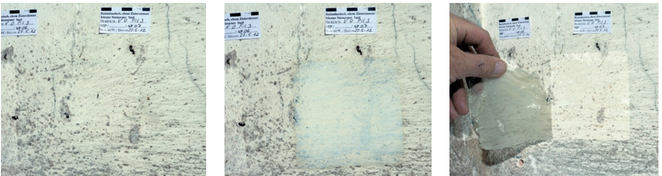
26–28. Arbeitsprobe 7 (rechts neben Probe 6): links der Vorzustand mit Vogelkot, Pilzbefall und Verschmutzung der Oberfläche; Mitte Zwischenzustand mit frisch aufgesprühtem weißlich opaken Latexfilm; rechts gereinigte Fläche beim Abziehen des Films, Verschmutzung und Pilzbefall reduzieren sich stark, instabile Teile der Kalkschicht werden abstrappiert
