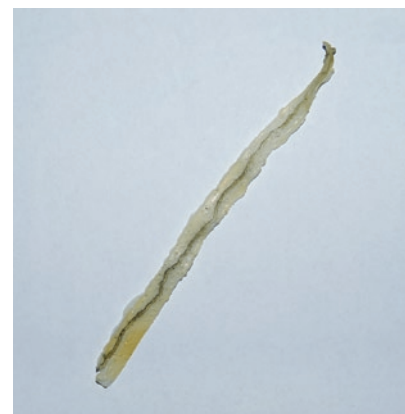
42. Abgezogene Latexfolie der Arbeitsprobe 9 aus der nordöstlichen Kehle: auch sie ist gelb verfärbt. Die aus dem Riss gebundene Verschmutzung ist gut sichtbar
