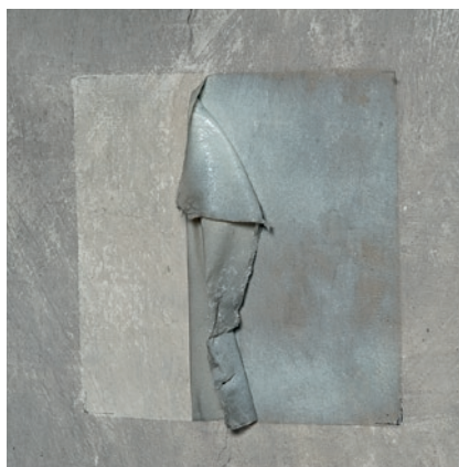
4. Probefläche 9 Minuten später, nach Auftrag des Latexfilms und testweisem Beginn der Filmabnahme nach ca. 15 Sekunden Auflagezeit; das Material SRF 2 NA ist noch nicht vollständig polymerisiert
