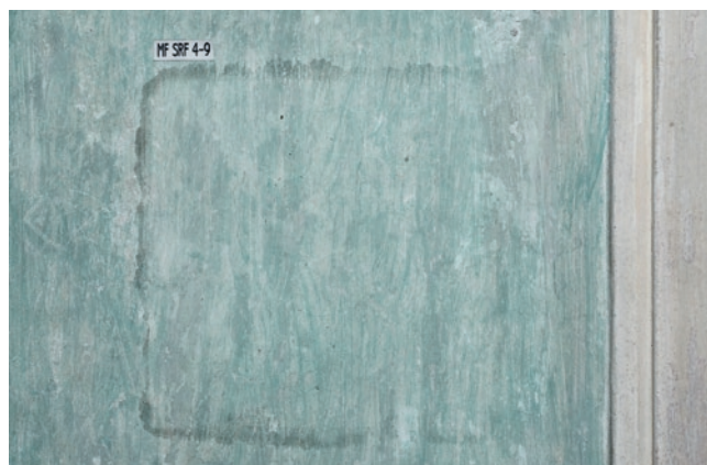
19. Nach dem Abziehen des Films ist keine negative Veränderung der Malschicht zu erkennen. Der dünne dunkelgraue Saum ist vermutlich eine durch den Feuchtigkeitseintrag hervorgerufene Konzentration der Schmutzpartikel. Zudem läuft der Sprühfilm am Rand sehr dünn aus. Dieser Rand kann mit einem Kautschukstück (Radierer) problemlos entfernt werden (rechter Rand)
