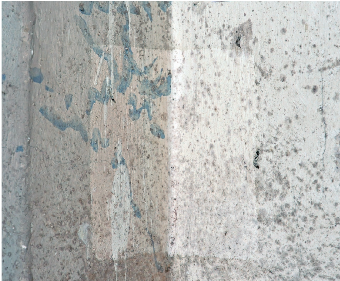
Raitenhaslach, ehem. Kloster, Steinerner Saal; Musterfläche auf unbemalter gekalkter Wandfläche und marmoriertem Pilaster nach der Reinigung mit SRF 2 NA – vgl. S. 25 (Foto: Klaus Klarner, München)
