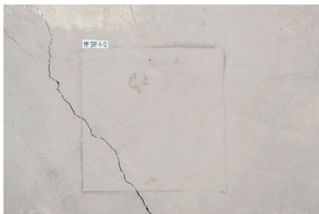
21. Musterfläche auf rosa farbiger Rücklage im Bereich des Chorstucks; die Randzone ist nach dem Abziehen des Films ebenfalls vergraut, ein deutlicher Reinigungserfolg ist nicht zu erkennen, da die Fassungs-schicht nur eine geringe Verschmutzung aufweist
