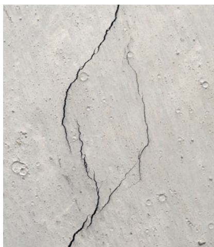
4. Probefläche 9 Minuten später, nach Auftrag des Latexfilms und testweisem Beginn der Filmabnahme nach ca. 15 Sekunden Auflagezeit; das Material SRF 2 NA ist noch nicht vollständig polymerisiert
