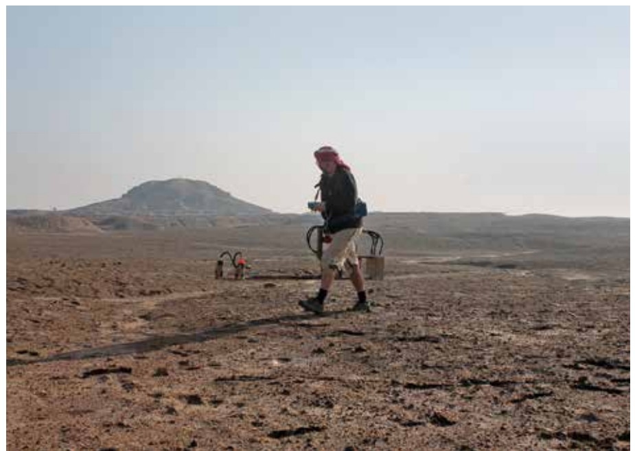
Jörg Faßbinder bei Messungen mit dem hochempfindlichen Cäsium-Magnetometer. Im Hintergrund die Ur III-zeitliche Zikkurat von Uruk (Foto: Simone Mühl)
