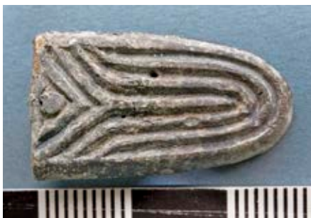
Riemenzunge aus Osterhofen. Oben in natura, rechts als Röntgenfluoreszenzspektrum dargestellt. Ergebnis: Blei und Zinn (alle Fotos: BLfD, Zentrallabor)
