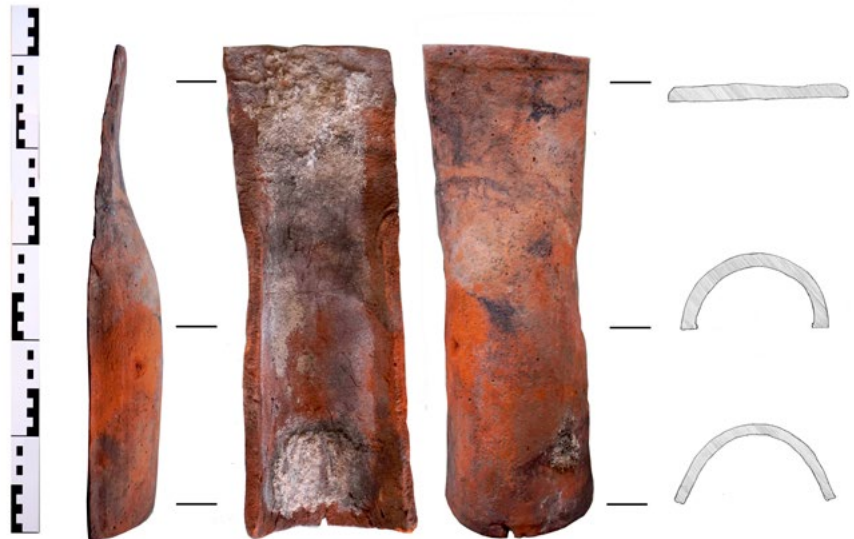
Bamberg, St. Gangolf, Firstanschlussziegel, Fund während der Instandsetzungsarbeiten 2017, Seitenansicht, Unter- und Aufsicht sowie Schnitte, Länge 49 cm, Breite 16 cm, Höhe 7,5 cm (Bearbeitung: Bernd Marr)
