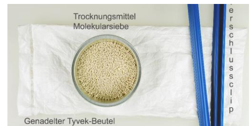
Abb. 5: Trocknungsmittelbeutel aus Tyvek. © BLfD
