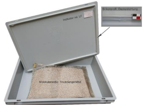
Abb. 4: Klimabox mit Feuchteindikator, Silikon-U-Profil-Dichtung und Trockenmittel in Stahlnetzgewebe. © BLfD
