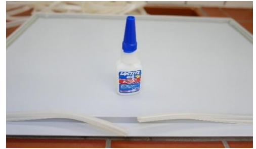
Abb. 3: Anbringen eines Silikon-U-Profiles zur Abdichtung des Boxdeckels. © BLfD
