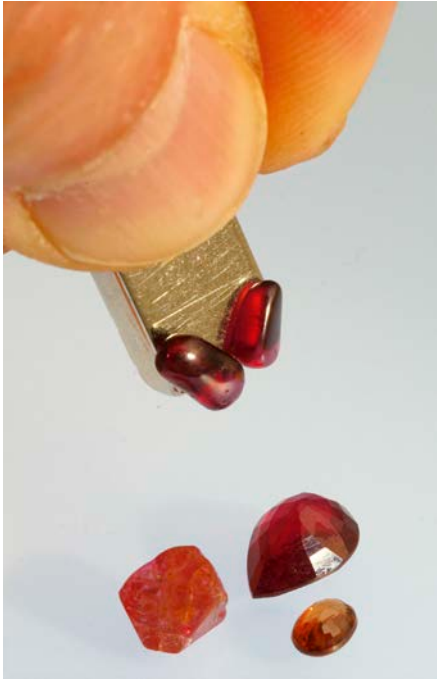
Wenig bekannt ist die Tatsache, dass sich Granate (Almandine) mit Hilfe eines Neodym-Magneten von gefärbtem Glas und anderen Edelsteinen unterscheiden lassen. Die Abbildung zeigt, wie zwei Almandine vom Magneten angezogen werden, gerade noch haften bleiben. Die anderen roten Edelsteine im Bild (von links nach rechts: Roter Spinell, Rubin und orangeroter Zirkon) lassen sich hingegen vom Magneten nicht merklich beeindrucken.
