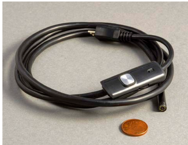
Smartphone-Endoskop, das einfach am Handy eingesteckt wird und das endoskopische Bild auf dem Handy-Display ausgibt. Der Vorteil liegt auf der Hand: Ein Großteil der Technik (Stromversorgung, hochwertige Bilddarstellung und Bildaufzeichnungsfunktion) ist bereits im Handy vorhanden, die technisch noch erforderliche Restmenge kann preisgünstig zugestöpselt werden. Rechts neben der 1 Cent-Münze ist der winzige Kopf des Endoskops mit integriertem LED-Lichtring zu erkennen.
