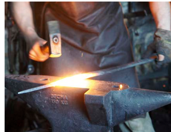
Schmieden eines Eisenschwertes (Foto: Martin Schreiner, Regensburg)
