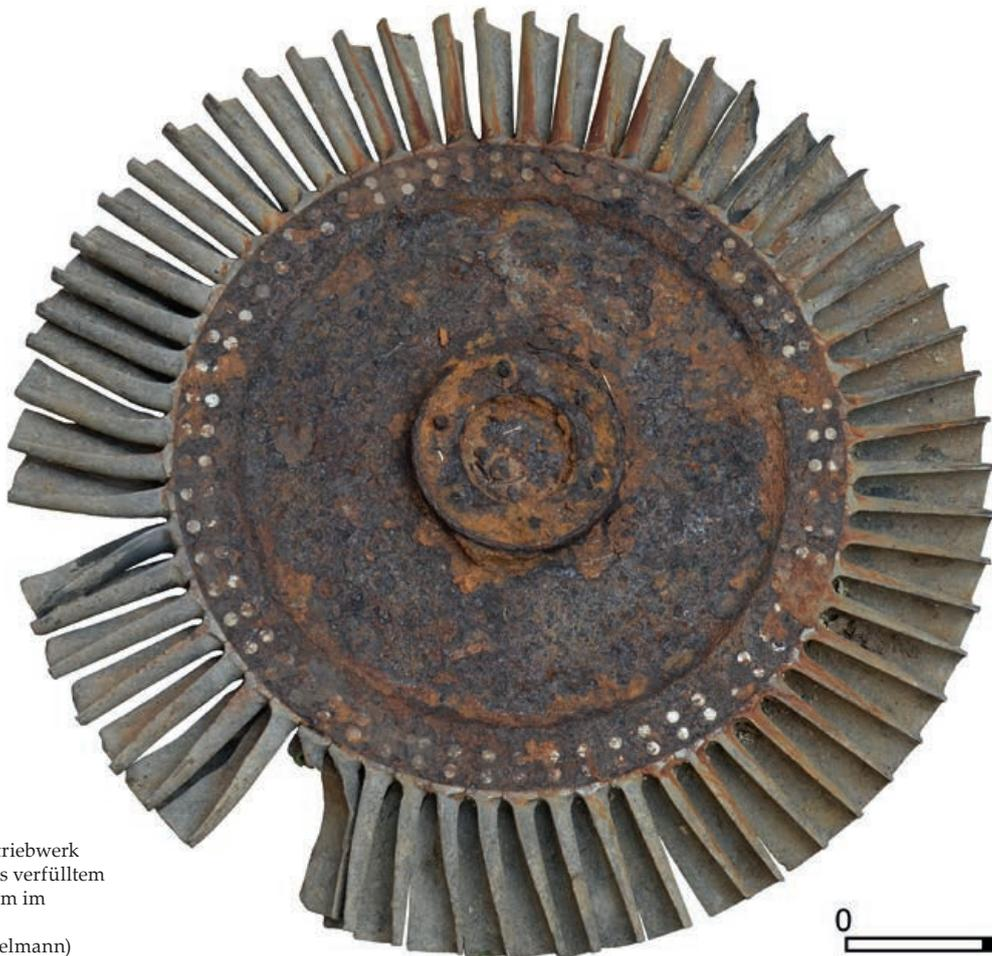
Turbinenrad (Strahltriebwerk Typ Jumo 004B-1) aus verfülltem Bombentrichter, 70 cm im Durchmesser
