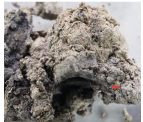
Inhalt des Holzdöschens: graue Substanz mit mikroskopisch kleinen Tröpfchen von reinem Quecksilber, Durchmesser des markierten Tröpfchens: ca. 50 µm (Foto: BLfD, Zentrallabor)
