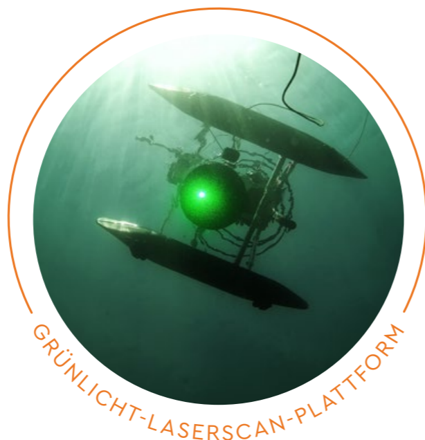
Laserscan aus der Perspektive eines Pfahlbaus: Blick von unten auf die Scan-Plattform. Laserscanning war eine von zwei Methoden zur Erstellung von 3D-Modellen, die das Deutsche Zentrum für Luft- und Raumfahrt (DLR) und das Centre Suisse d'Electronique et de Microtechnique (CSEM) an der Roseninsel testeten. (Foto: DLR)
