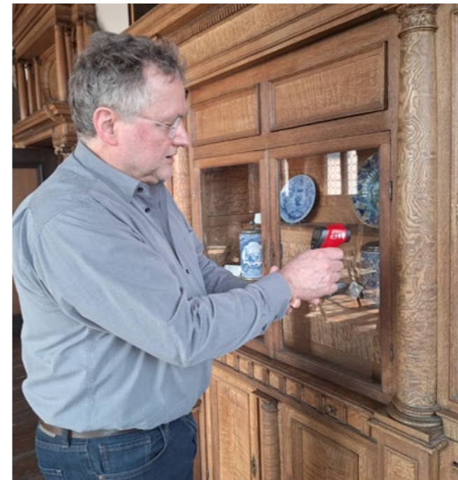
Messung der Oberflächentemperatur mittels Infrarot an der Holzvertäfelung im Familiensaal (um 1600), Fembo-Haus Nürnberg (Foto: Jana Stolzenberger)
